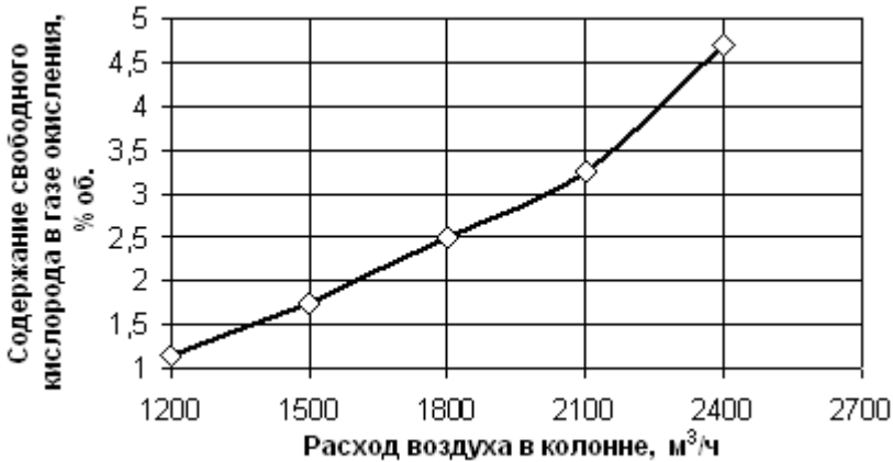
Рис. 2.2. Зависимость содержания свободного кислорода в газах окисления от расхода воздуха в окислительной колонне при получении дорожных битумов
