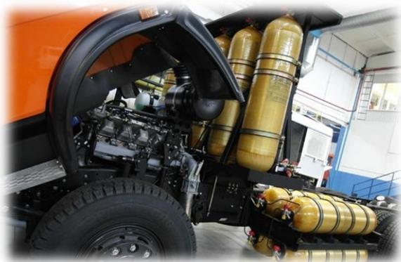
Автомобили КАМАЗ комплектуются несколькими типоразмерами баллонов.
