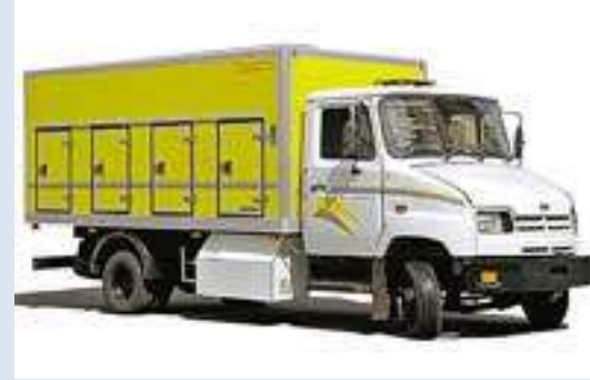
Изотермический автофургон, оборудованный турбохолодильной установкой на ДМЭ
