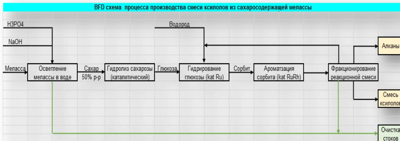
**3.2 Материальный баланс не учитывает воду для осветления мелассы, указана только вода образующееся в процессе реакции ароматизации-конденсации сорбита.**
