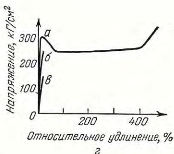
Рис. VII.7. Зависимость надмолекулярной структуры и механических свойств изотактического кристаллического полипропилена от режима кристаллизации (различная длительность прогревания расплава при 180° С): а — 5 сек; б — 20 сек; в — 60 сек; г — диаграммы растяжения образцов а — в 42 .
