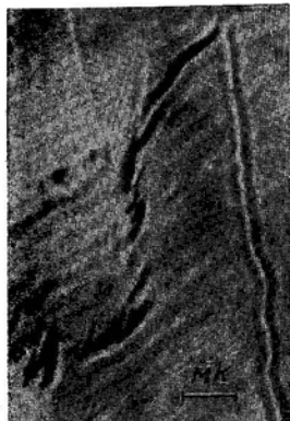
Рис. II. 17. Начальная стадия кристаллизации хлоропренового каучука 32 .
