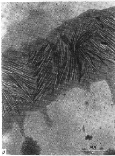
Рис. П.20. Различные стадии структурообразования в полиэтилене: a и б — начало структурообразования; в — сложные формы агрегации пластин; — начало образования монокристаллов и картина отдельных пластин, соединенных фибриллами; д — пластины, группирующиеся в сферулитах; е — единственный кристалл 26,46.
