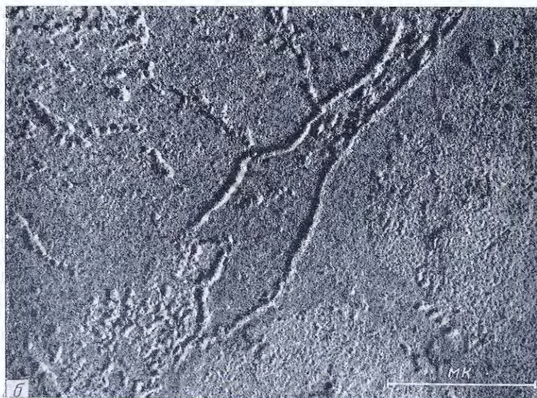
Рис. II.8. Фибриллы каучуков 20 : а — бутадиен-стирольный СКС-30; б — бутадиеновый (СКБ)
