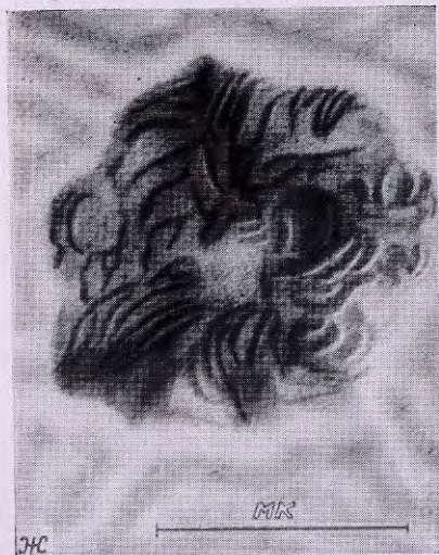
← Рис. П. 18. Различные стадии структурообразования в хлоропреновом каучуке (а — д) и его вулканизате (е — ж) 20, 31, 32, 39.
