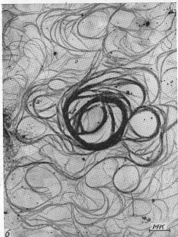
Рис. II.2. Пачечные и более сложные фибриллярные структуры полимеров: а — нагревая соль полиакриловой кислоты; б — полиамид 20,25,27.
